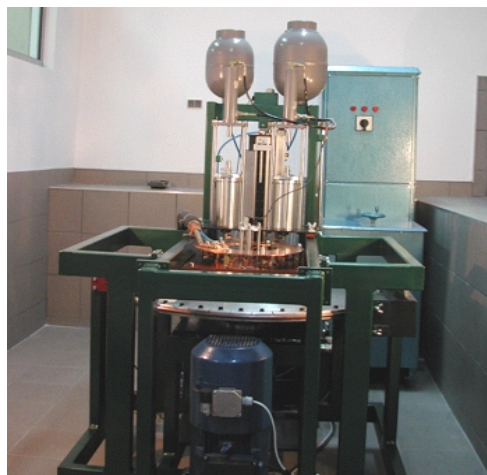
Fot.1. Widok ogólny stanowiska do badań odporności na ścieranie przewodów jezdnych w warunkach eksploatacyjnych
